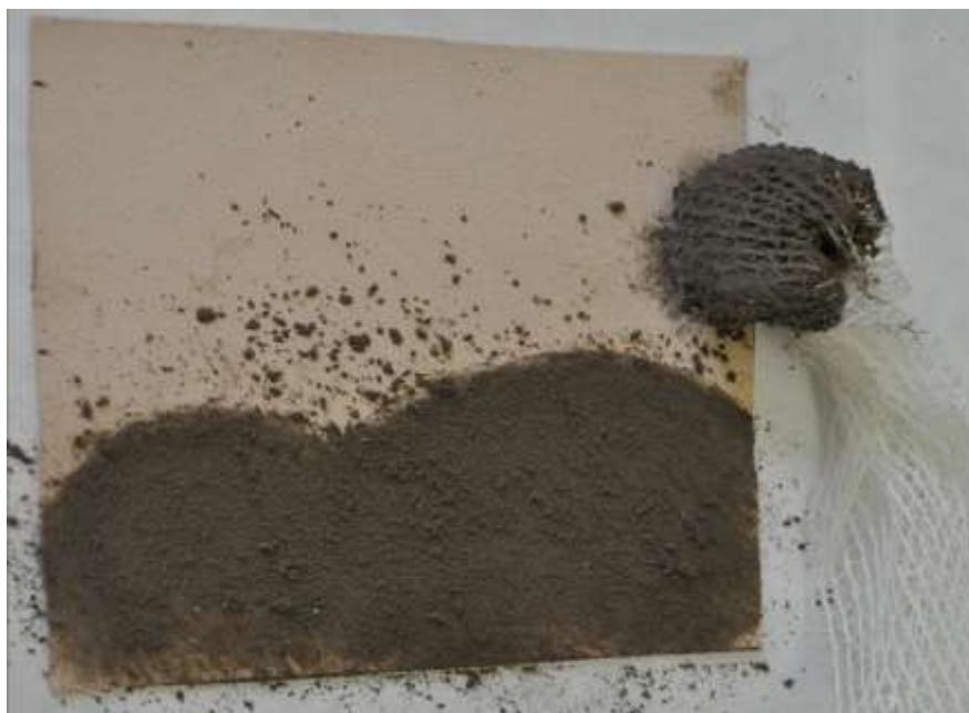
Obr. 1 Nanášení prachu na vzorek třísločiněné usně
